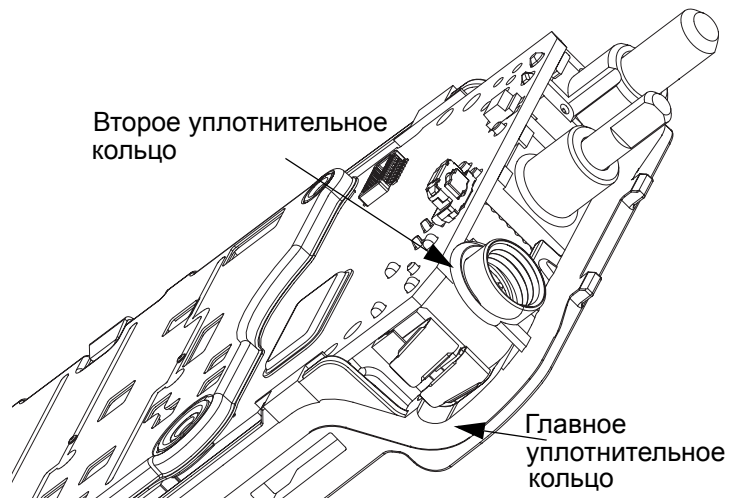
Рис. 5-15. Установка второго уплотнительного кольца.
