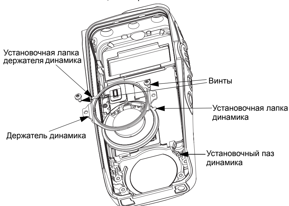
Рис. 5-11. Установка динамика (Модель с дисплеем).
